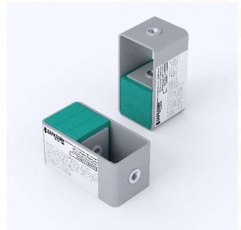
**Виброизоляционное крепление виброподвес Барклайн ВиброСорб ВЕНТИ ПРО1** – Виброизоляционное крепление профессионального уровня эффективности. Сквозь виброизоляцию производится закрепление к поверхности через две точки крепления. Благодаря виброизолированному креплению звук не проникает с поверхности стены и потолка на возводимый каркас.
