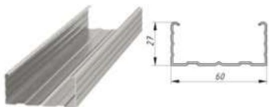
**Профиль ПП60x27 толщиной 0,6 мм** – это С-образный (прямоугольный) элемент из оцинкованной стали, предназначенный для создания металлического каркаса для конструкций из гипсокартона и облицовки стен.
