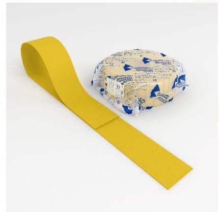
**Виброизоляционная полоса ВиброСорб 120мм** – высокоэффективная демпферная лента из эластомера. Связывает колебания, препятствует проникновению звука в конструкции и звукоизоляционные облицовки. Применяется для демпфирования строительных конструкций: Монтируется на клей строительный контактного типа.
