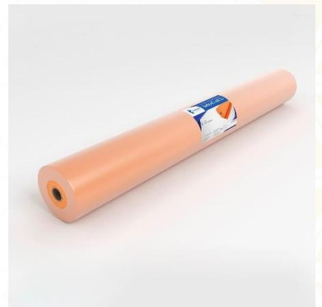
**Виброизоляционная подложка ВиброСорб** – высокоэффективная демпферная виброизоляционная подложка из эластомера. Связывает колебания, препятствует проникновению звука в помещение и из него. Применяется как разделительный слой мембраны между листовыми материалами, как подложка под ламинированный паркет, паркетную доску, свободнолежащие несущие покрытия, сборные основания. Применяется как звукоизоляционная подложка в системе звукоизоляции пола с заливкой цпс стяжки.
